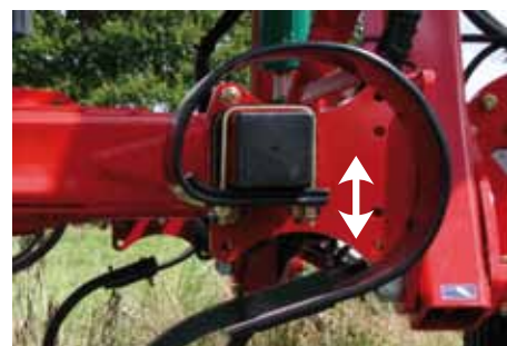
4 zęby (2x2) pracujące w śladach kół ciągnika mogą być ustawione 5 cm głębiej niż pozostałe dla spulchnienia ugniecionej gleby.
